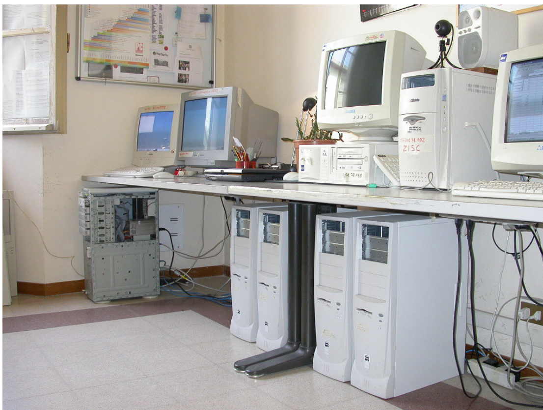
Figura 26 – Il cluster realizzato: in basso da sinistra il nodo master ed a destra i 4 nodi dual Athlon; in alto da sinistra i due monitor per la console, il firewall con il suo monitor ed una workstation
