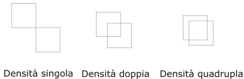
Figura 2.10: Funzioni di scala Haar a densità singola, doppia e quadrupla
