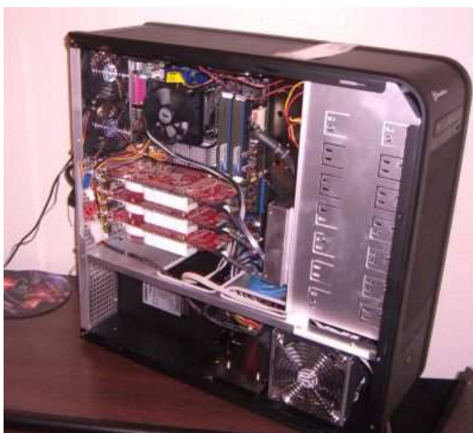
Figura 4.1: Un sistema Crossfire con tre schede video.
