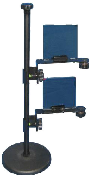
Figura 3.2: Supporto dei filtri polarizzanti.
