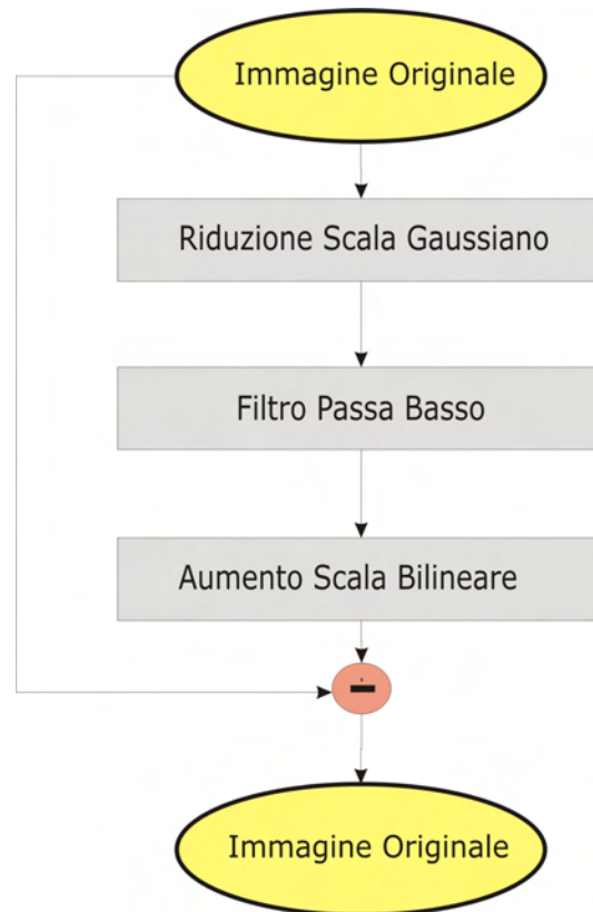
Figura 4.8: Schema logico dell' High Boost Filter.
